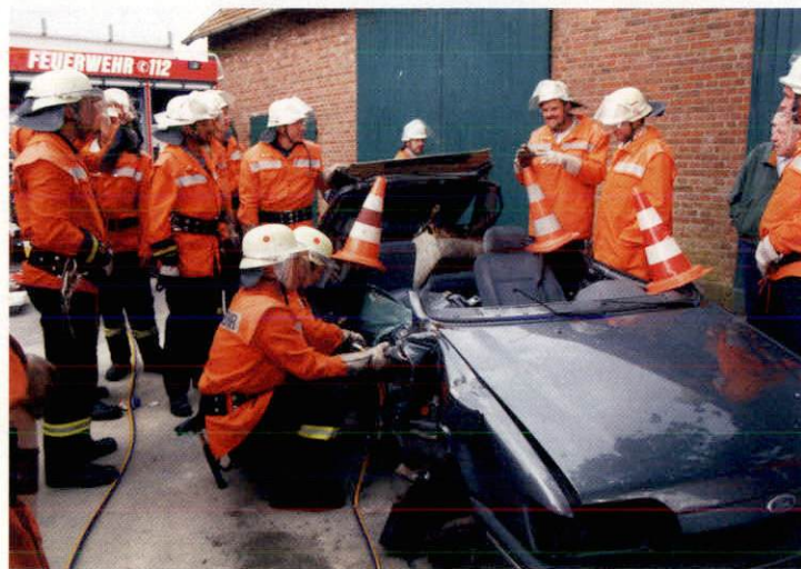
Mit hydraulischer Schere und Spreizer läßt sich das Fahrzeug beinahe wie Papier durchschneiden
