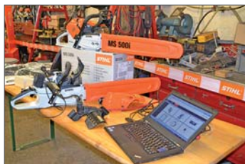
Fehlerfinden wie bei Fahrzeugen: die digitale Technik macht auch bei Motorsägen möglich.
