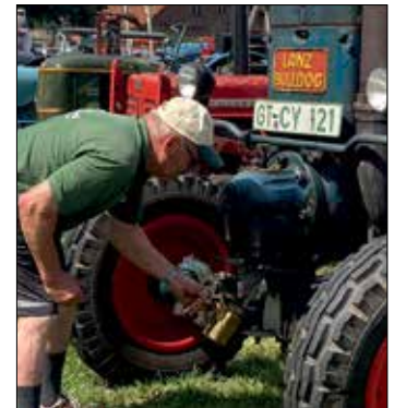
Karl-Heinz Wittenbrock muss mit Petroleum vorglühen, bevor er den Lanz Bulldog ankurbeln kann
